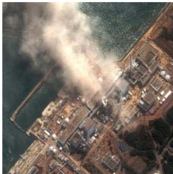
Explosión de hidrógeno, ruptura de al contención secundaria y fusión parcial del núcleo de combustibles nucleares en Fukushima
